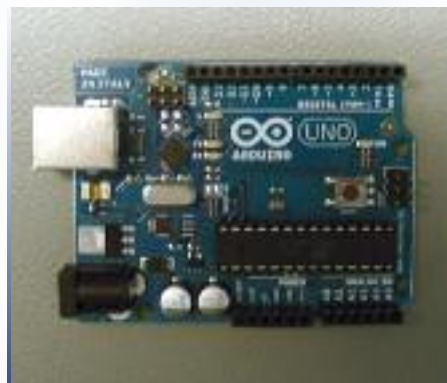
Die Arduino-Entwicklungsplatine ist eine Open-Source-Hardware
