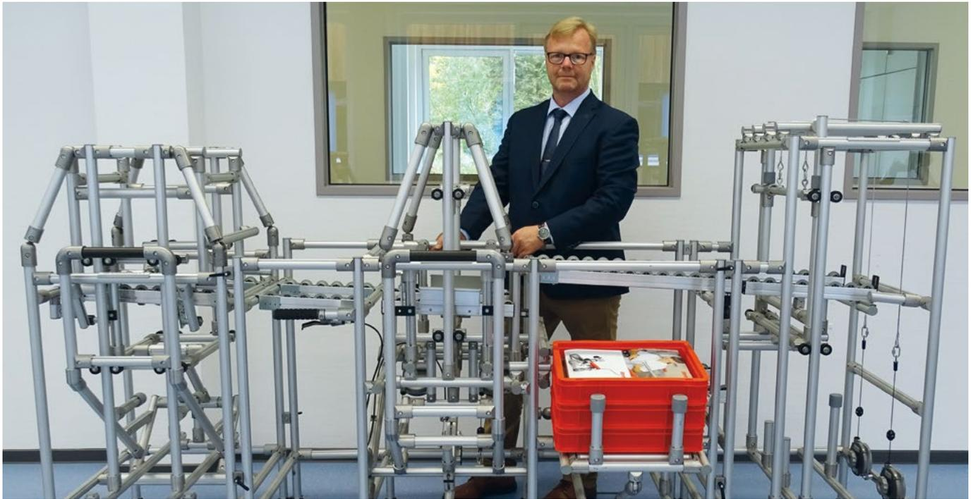
**Mit dem Profilrohrsystem entstehen intelligente Karakuri-Anwendungen, die die Gesetze der Schwerkraft und der Mechanik für sich nutzen. Prof. Dr.-Ing. Ahrens freut sich über die neue von der Firma item gestiftete Anlage, die in Lehre und Forschung an der NORDAKADEMIE eingesetzt wird.**
